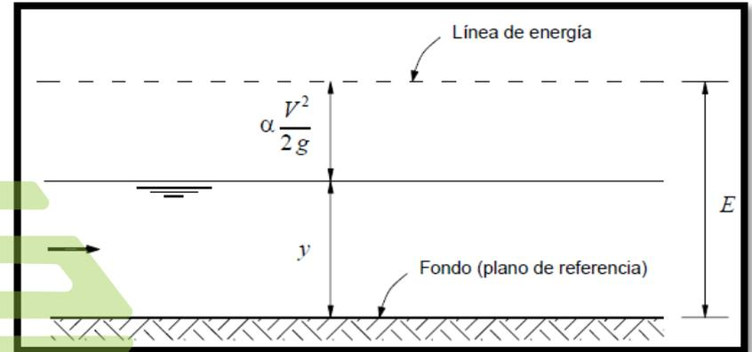
Donde  $z=0$  (ya que el nivel de referencia es el fondo del canal) obteniéndose la ecuación de la energía específica.
