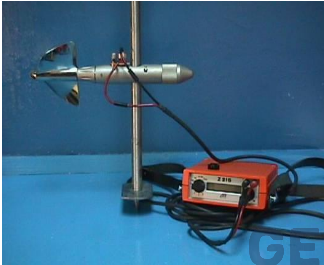
Correntómetro OTT con varilla graduada para aforo con vadeo
